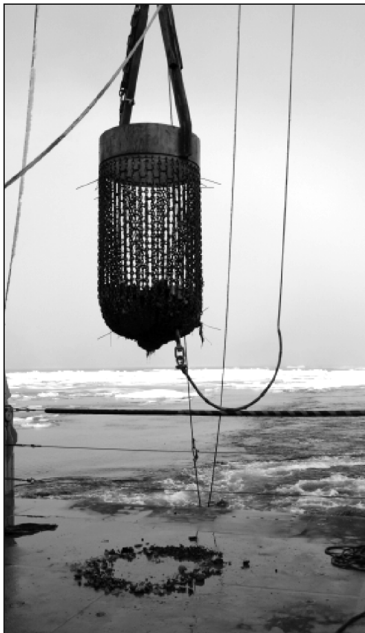
Рис. 10. Глубоководная драга, использованная на ледоколе «Nealy» для сбора образцов горных пород с морского дна в ходе экспедиции 2008 г.
