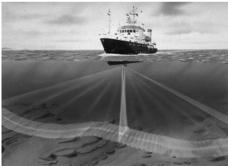
Рис. 3. Волновая геометрия многолучевого эхолота, способного «сканировать» большие участки морского дна (рисунок Atlas Hydrographic)
